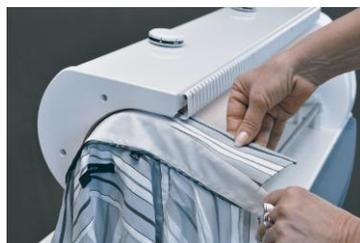
**Prednja strana košulje:** Pri glačanju prednje strane košulje položite otvore za gumbice preko lijevog kraja valjka, uspravno na njega sa šavom na samom kraju valjka. Glačajte od rupa do otvora za rukav. Sada, pomaknite košulju i glačajte mimo otvora za rukav, sve do bočnog šava. Stranu sa gumbima glačajte iznutra prema van na način da gumbi budu uz oblogu valjka.
