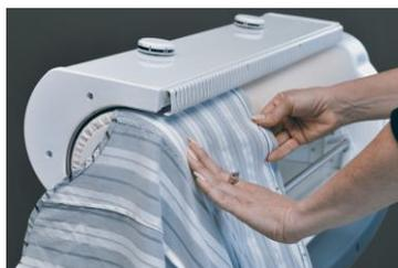
**Leđa:** Počnite od bočnog šava. Vucite košulju preko valjka, sve do otvora za rukav. Izvucite taj dio. Započnite od ruba valjka i zaobiđite otvor za rukav, zatim povucite košulju dalje na valjak i izgladajte cijelu dužinu leđa do drugog otvora za rukav. Povucite dalje košulju niz valjak i glačajte zaobilazeći otvor za rukav.
