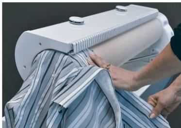
**Ovratnik:** Ovratnik izgladajte propuštajući ga preko lijevog kraja valjka, a zatim ga zaokrenite prema dolje i lagano pritisnite u zategnutom položaju. Zaustavite uređaj za glačanje kada gumbi dođu do glačala (grijače ploče)
